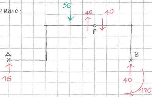
PUNTO 1.2 ————— verifico  $R_M(B)$  utilizzando il metodo della POTENZA
