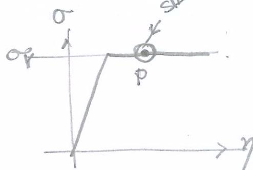
① rottura della trave: tutte le fibre si sono snervate
